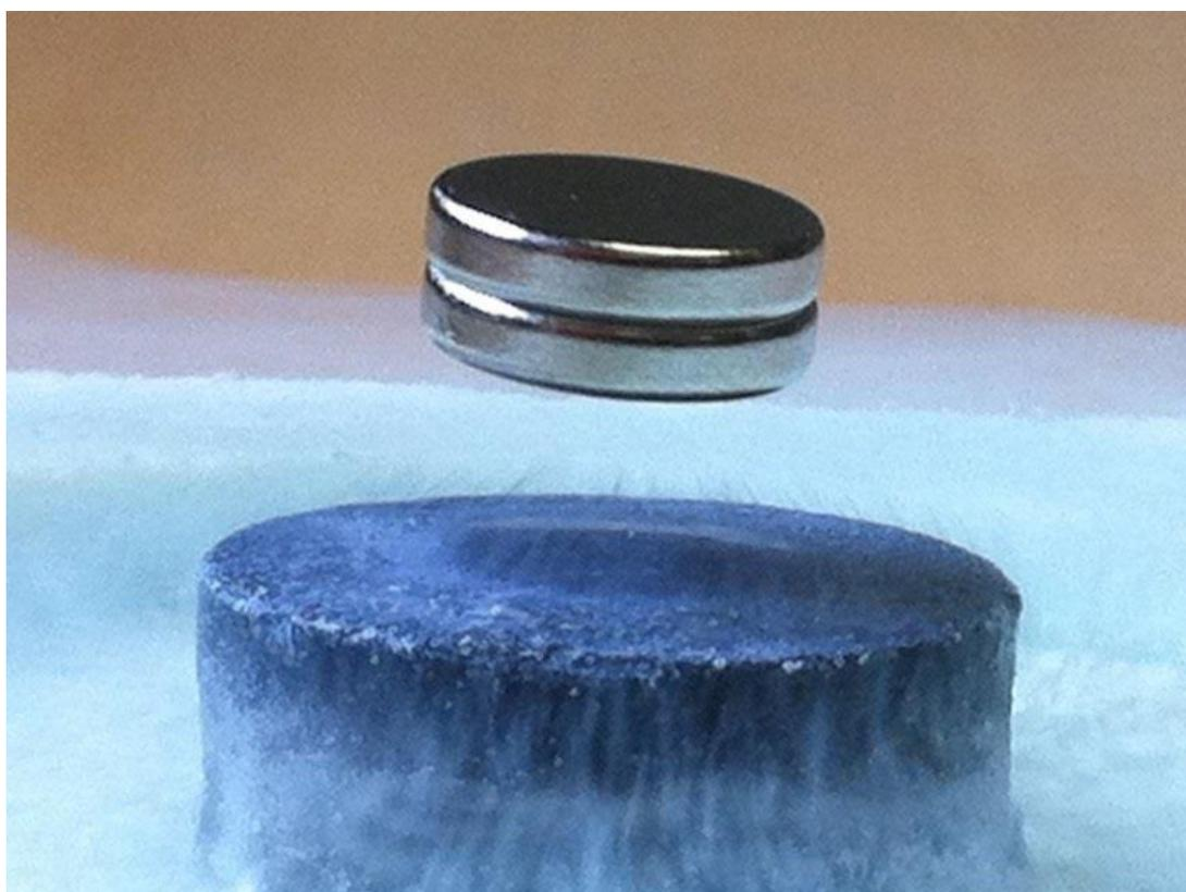
**Магнит левитирует над сверхпроводящим кольцом, в котором течёт электрический ток.**
